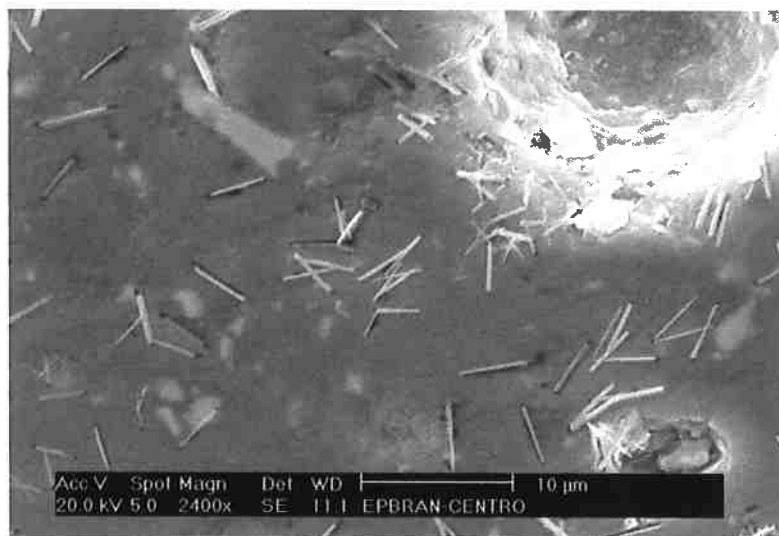
Figura 5.18: Microscopia eletrônica de varredura da amostra NPBRAN, com aumento de 2400x e com o uso de elétrons secundários.
