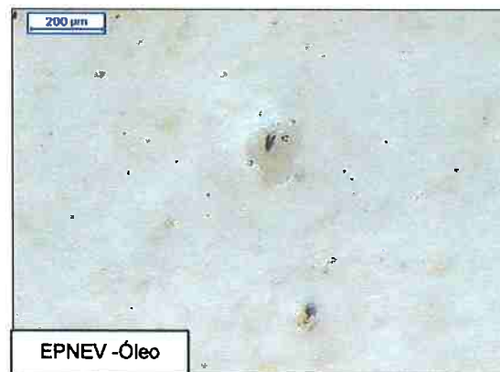
Figura 5.7: Análise de imagens da amostra EPNEV manchada com óleo de oliva e lavada em água quente.
