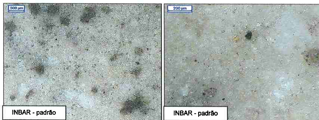
Figura 5.8: Análise de imagens da amostra INBAR padrão (sem manchamento).
